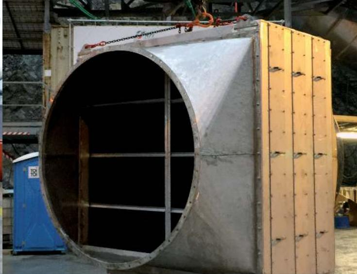
Progettazione e realizzazione di sistemi "box type" per grossi impianti di canalizzazione. Sia per la rimozione di gocce liquide di processo, sia in sistemi di umidificazione di correnti di aria secca. *Design and manufacture of "box type" systems for large duct systems. Both for the removal of process liquid droplets and for humidification systems of dry air flows.*
